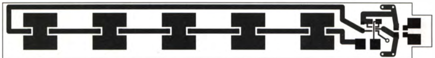
Bild 3: Layout der Platine; Abmessungen 205,5 mm x 27 mm; Platine auf 90 % verkleinert dargestellt
