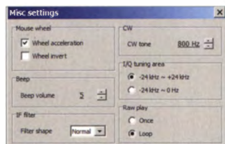
Bild 14: Das Untermenü Misc settings erlaubt unter anderem die Einstellung der Breite der Spektrumsdarstellung.
