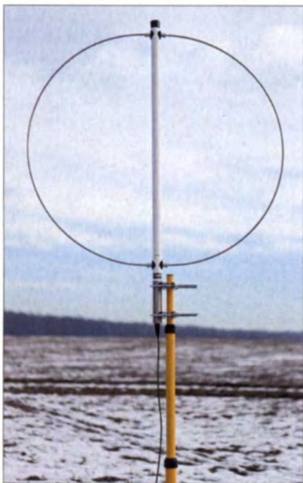
Die breitbandige Empfangsloop Rafansys LRX-30 ist für den Außenbetrieb konzipiert.
