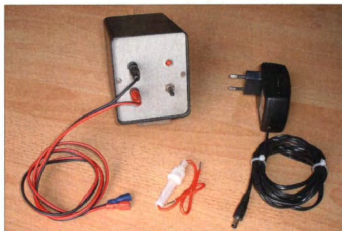
Bild 1: Ansicht des Ladegeräts samt Steckernetzteil; lässt sich auf der Gehäuserückwand kein Einbausicherungshalter unterbringen, ist in die Leitung zum Akkumulator unbedingt eine Leitungssicherung, wie in der Mitte zu sehen, einzufügen.
