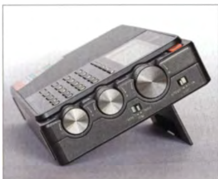
Tonblende und Schalter für LCD-Beleuchtung auf der rechten Gehäusesseite
