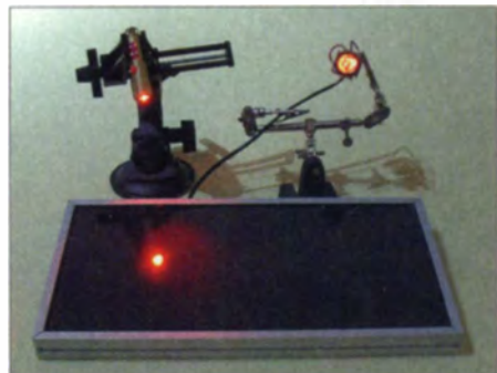
Bild 2: Schon durch die Bestrahlung einer Solarzelle mittels einer LED lassen sich Geräte mit geringer Leistungsaufnahme betreiben.
