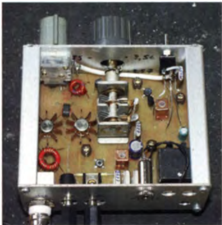
Bild 1: Innenansicht des MAS-Transceivers für den Einsatz im CW-Bereich des 80-m-Bands
