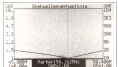
Bild 3: Das mit einem FA-VA gemessene SWR nach 10 m Koaxialkabel Aircell 7
