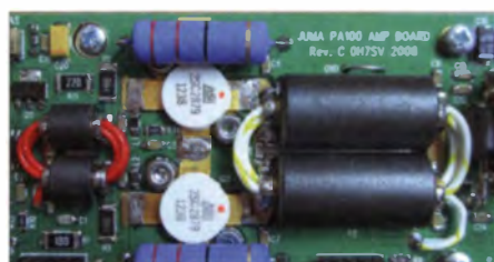
Bild 2: Platine der JUMA PA 100, rechts der Ausgangsübertrager Foto: DL2EWN
