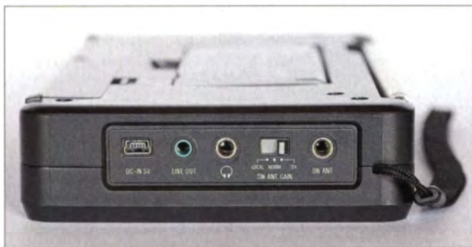
Anschlussfeld und Eingangsabschwächer auf der linken Gehäusesseite
