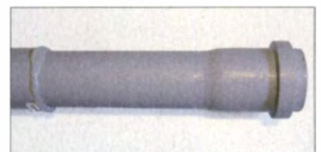
Bild 2: Unterbringung des Summers in einem HT-Rohr aus dem Baumarkt
