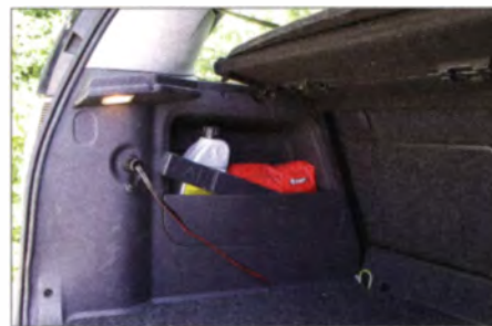
Bild 3: Mehr ist im Kofferraum vom Funkgerät nicht zu sehen. Das Bild zeigt aber auch die größte Schwachstelle dieser Installation: Der Hersteller hat eine ziemlich windige Steckdose spendiert, die immer wieder Kontaktprobleme hat. Handelsübliche Steckdosen brauchen aber einen kleineren Lochdurchmesser.
