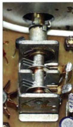
Bild 7: Ansicht des im VFO verwendeten UKW-Drehkondensators; alternativ einsetzbare Kondensatoren sind bei [6] erhältlich.
