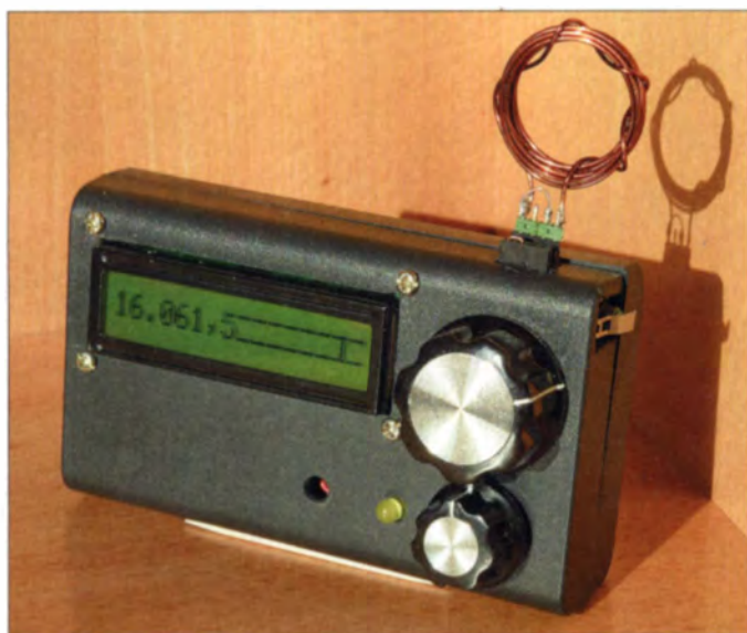
Bild 6: Mit dem eingebauten Frequenzzähler ist Maxi-Tweety ein komplettes Messgerät. Der kleine Schalter rechts oben dient zur Umschaltung auf LC-Messung.
