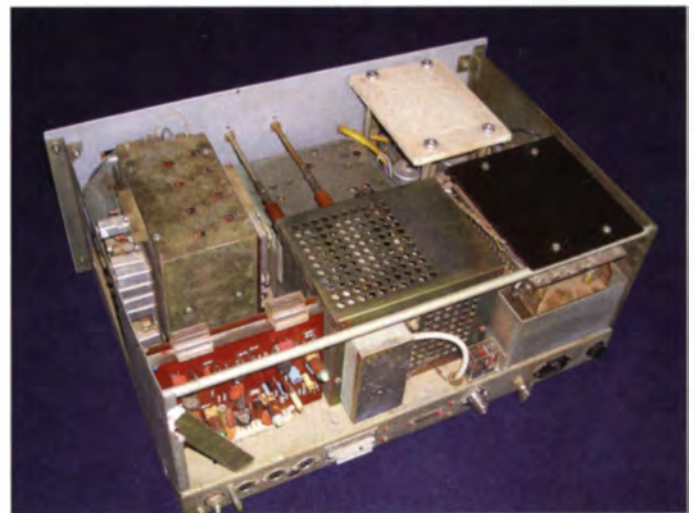
Bild 6: Ein Blick von unten auf das Chassis des Teltow 210 zeigt den modularen Aufbau; Schwarzweiß-Aufnahme aus dem FA 6/74.
