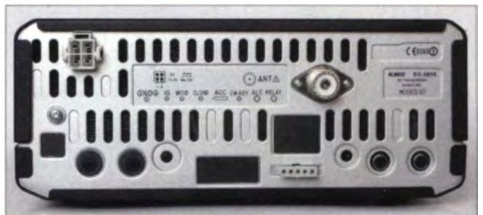
Bild 2: Auch die Rückfront des DX-SR9E unterscheidet sich kaum vom DX-SR8E. Genaue Betrachtung zeigt anstelle von Abdeckungen links drei Klinkenbuchsen IQ, MOD und CLONE, wichtig für den SDR-Betrieb.
